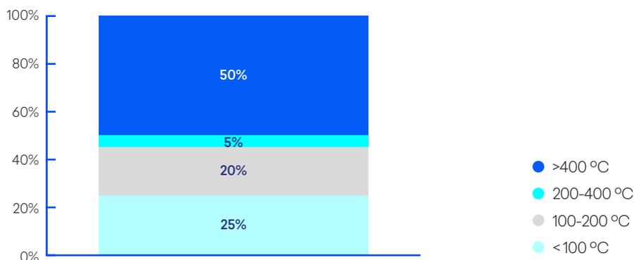
Figura 20 - Necessidades de calor industrial por gama de temperaturas de operação<sup>42</sup>
