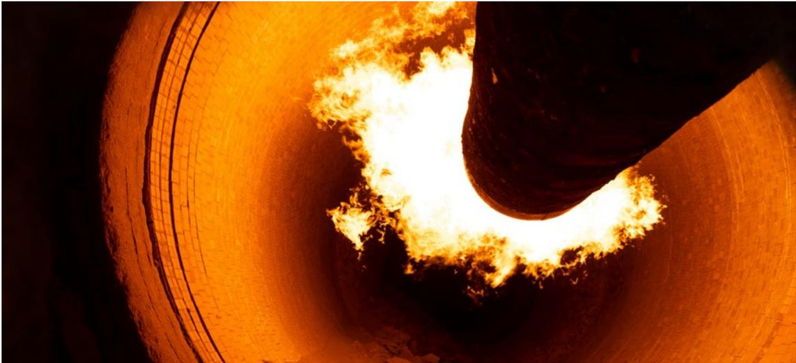
Figura 15 - Forno rotativo de cimento.
